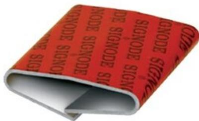
Signode 114 P Push-Type-Siegel sind speziell für den Einsatz mit dem manuellen Siegelgerät RCD-1431, dem pneumatischen Siegelgerät PRHR-114 oder dem pneumatischen Siegelgerät RCNS2-114 auf 32-mm-Magnus-Stahlbändern konzipiert. Druckdichtungen werden typischerweise dort verwendet, wo das Band gespannt wird, indem die Spitze des Spanners gegen die Dichtung gedrückt wird. Die überlappenden Flansche sind speziell dafür ausgelegt, höheren Spannungsniveaus standzuhalten.
