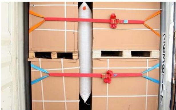
Verriegelungssystem am Ende der Ladung für trockene Behälter.
